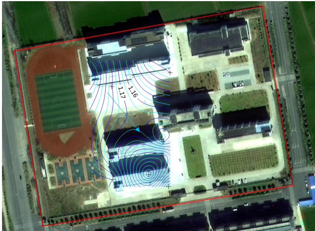
图 3.3-4 调查地块内部地下水流向图（根据地勘数据绘制）
