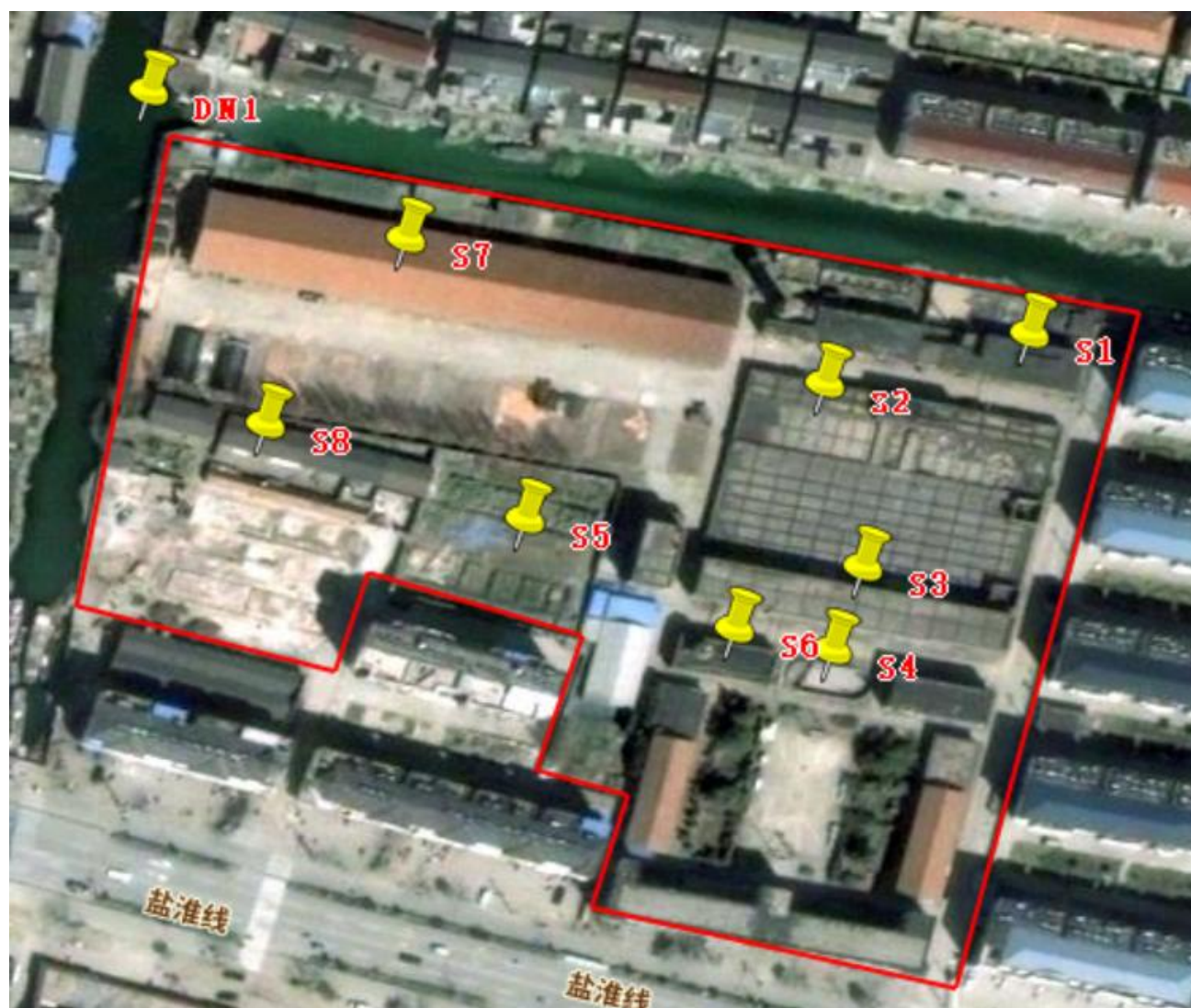
图 4.3-1 土壤和地下水监测点位布置图
