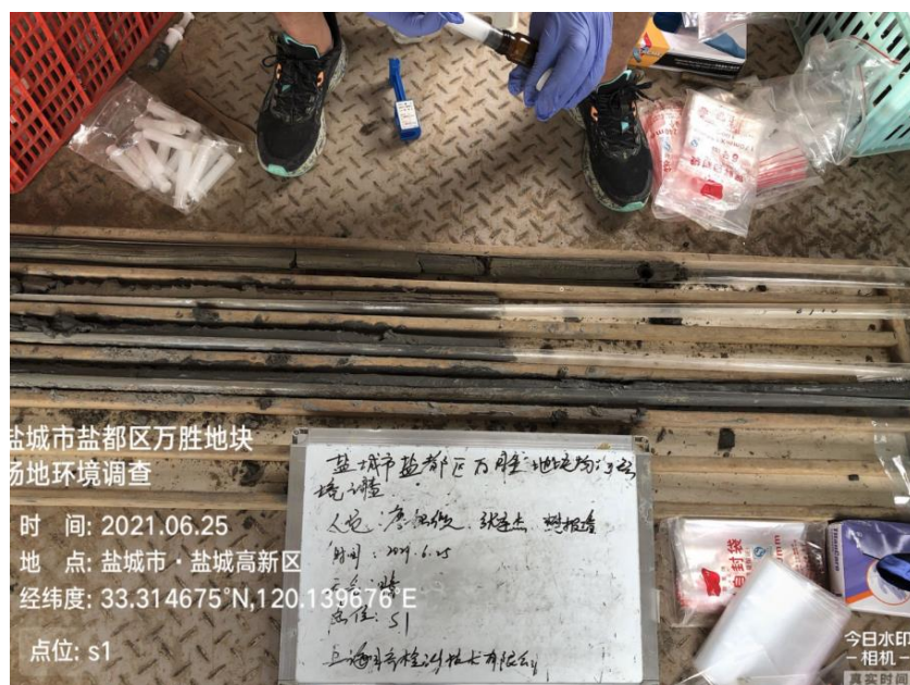
图 5-10 挥发性有机物现场采样照片
