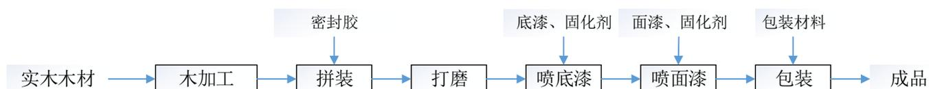
图 3.6-1 无锡市家具一厂生产工艺流程图
