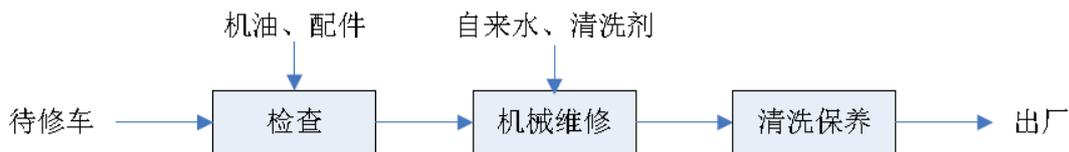
图 3.6-9 万宝行汽车(塘南路)生产工艺流程图
